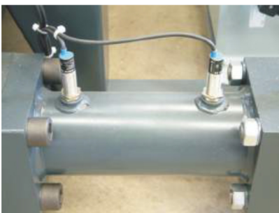
Cylindre de remplissage avec fin de course et trémie de remplissage étanche à la poussière
